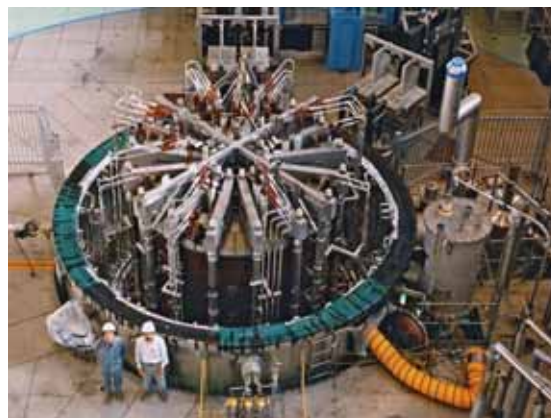
図 23 クライオスタット内に設置された CS モデルコイル
