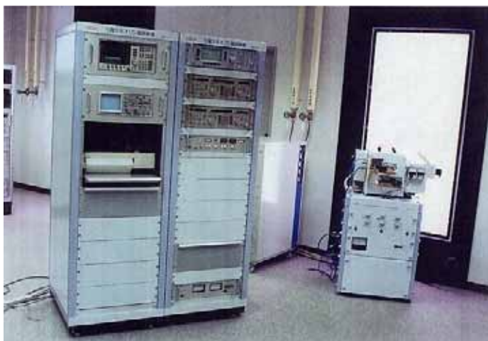
図5 ジョセフソン素子を用いたオゾン観測装置 13)
