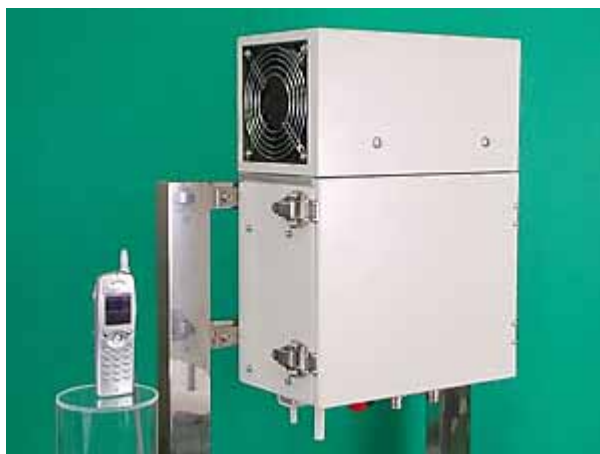
図 3 超電導フィルタを用いた小型受信増幅装置の試作例 5)
