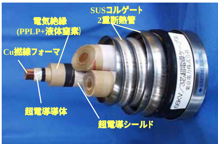
図 3 3心一括型超電導ケーブル
