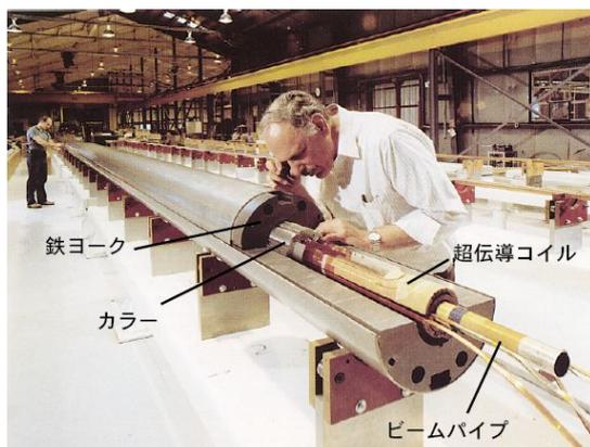
図 3-1 加速器用超電導磁石の例 (SSC 双極電磁石)
